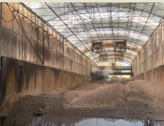
義竹場發酵區 自動翻堆機每天定時運作，配合底部強制的曝氣系統，確保氧氣能均勻進入堆體的每一吋
