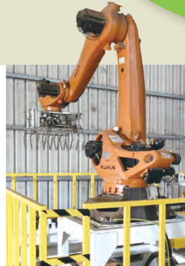
義竹場智慧機械手臂 導入KUKA機械手臂進行自動堆疊，落實工業4.0智慧製造
